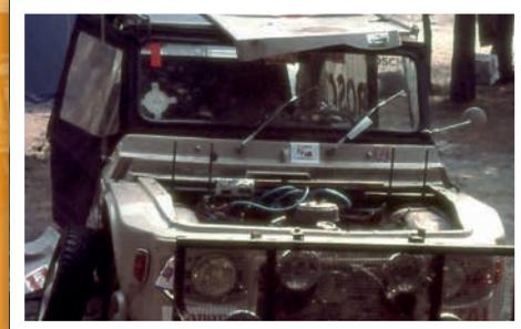
Quatre tiges filetées traversent le capot. Il fallait donc dévisser pour retirer les roues de secours afin d'avoir accès à la mécanique. Ces tiges sont soudées ou vissées sur des tubes carrés eux-mêmes fixés au tubulaire avant.
