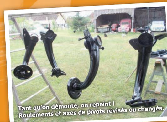
Tant qu'on démonte, on repeint ! Roulements et axes de pivots révisés ou changés.
