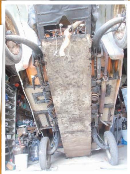
Levage partiel de la bête pour mieux travailler dessous. Quand on n'a ni pont élévateur ni fosse, on se débrouille. Gros pots de suspension d'Ami8, ouverts pour faciliter les réparations et régler la tension des ressorts.
