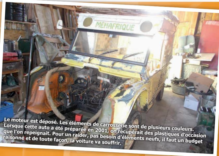
Le moteur est déposé. Les éléments de carrosserie sont de plusieurs couleurs. Lorsque cette auto a été préparée en 2001, on récupérait des plastiques d'occasion que l'on repeignait. Pour un raid, pas besoin d'éléments neufs, il faut un budget raisonné et de toute façon, la voiture va souffrir.
