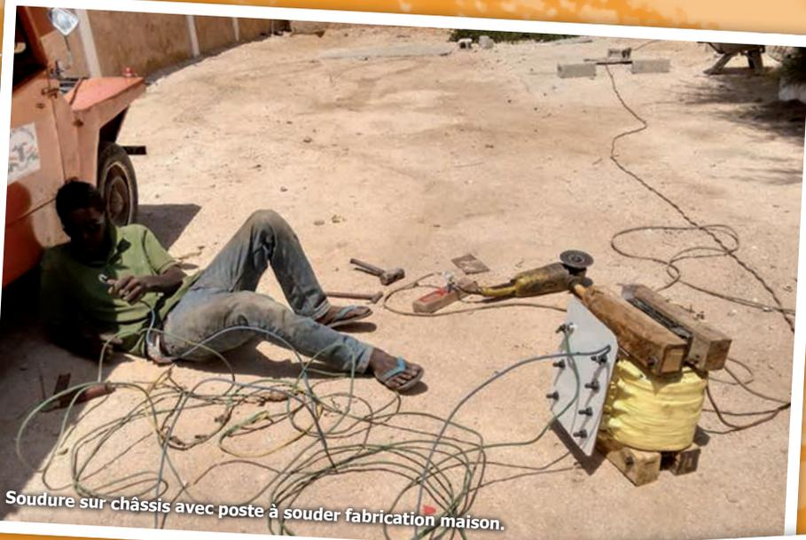
Soudure sur châssis avec poste à souder fabrication maison.
