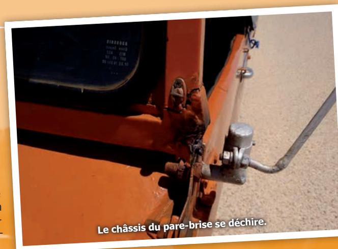
Le châssis du pare-brise se déchire.
