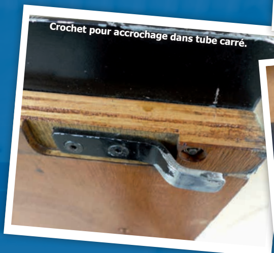
Support latéral avec la lumière et 3 points de fixation dans tubulure.
