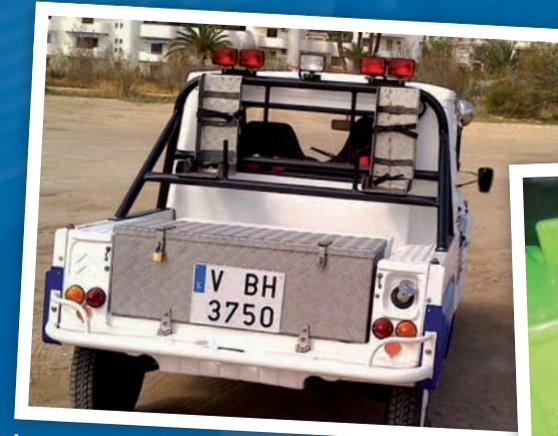
La malle « spécial raid », gain de poids en supprimant le hayon arrière, construite sur mesure.
