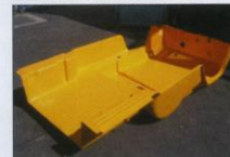
La baignoire en fibre de verre et son assemblage sur la plateforme Citroën.
