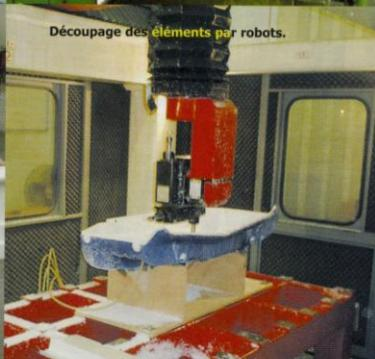
Découpage des éléments par robots.
