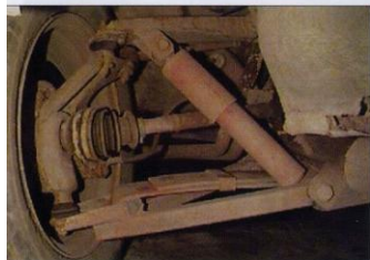
La 2CV Super America, la Gringa et la Gringo étaient dotées d'une robuste et archaïque suspension ancrée sur un châssis de facture classique lui aussi, composé d'une poutre et de brancards à l'avant comme à l'arrière et relié aux roues par de solides triangles contrôlés par d'antiques ressorts à lames transversaux inférieurs.
