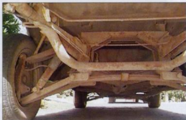
La 2CV Super America, la Gringa et la Gringo étaient dotées d'une robuste et archaïque suspension ancrée sur un châssis de facture classique lui aussi, composé d'une poutre et de brancards à l'avant comme à l'arrière et relié aux roues par de solides triangles contrôlés par d'antiques ressorts à lames transversaux inférieurs.
