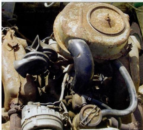
Comme révélé par la carte grise, le moteur est bien un 602 cm<sup>3</sup>. Le petit bicylindre n'est malheureusement alimenté que par un carburateur à simple corps et son filtre à air n'est pas du type qu'on trouvait sur les modèles PO, soit à bain d'huile ou encore doublé.
