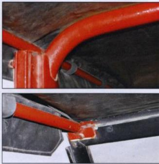
un autre tube de section carrée et ajusté à la hauteur des montants.
