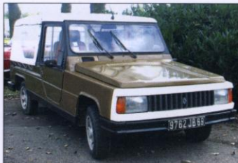
Dernières moutures de la Rodéo, à gauche, dernier modèle assis sur une plate-forme Renault 6 et à droite, la Rodéo new-look, à la carrosserie faits d'éléments facilement démontables vissés sur une structure posée sur un châssis de R4GTL.
