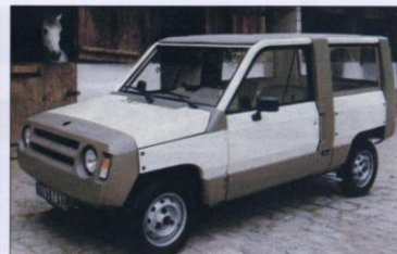
Dernières moutures de la Rodéo, à gauche, dernier modèle assis sur une plate-forme Renault 6 et à droite, la Rodéo new-look, à la carrosserie faits d'éléments facilement démontables vissés sur une structure posée sur un châssis de R4GTL.
