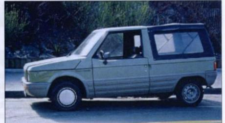
Une ligne un peu pataude : la faute à ses petites roues d'AX et à un porte à faux nécessaire au logement du 1124 cm<sup>3</sup> PSA.
