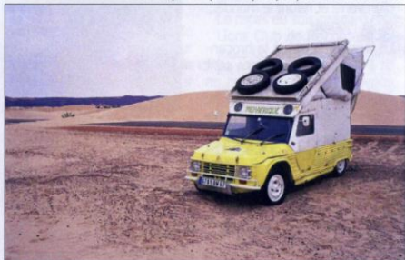
Et l'une des raisons de ces défaillances était le poids de l'engin, 1250 kg, soit nettement plus que ce qu'indique sa plaque de tare.
