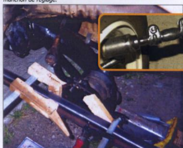
La roue démontée facilite les opérations en permettant un accès aisé au manchon de réglage.
