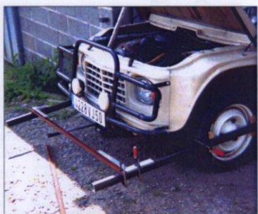
Installation du dispositif de réglage improvisé, côté roue saine en haut et côté malade ci-dessous.
