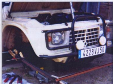
La roue démontée facilite les opérations en permettant un accès aisé au manchon de réglage.
