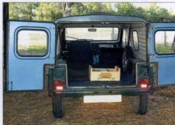
Des emprunts ont été faits à la fourgonnette 2CV au niveau des fermetures et peut-être du vitrage, d'après le photographe, la teinte de l'ABS utilisé est le bleu ciel apparent au verso des portes. Le pare-chocs arrière n'est pas d'époque et les batteurs de la suspension arrière sont absents.
