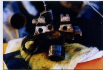
Extraction sur le genou du piston et des deux joints dont la détérioration est la raison de leur changement et de la reféction complète des étriers.
