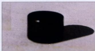
Le piston qui fait arrêter la machine. Brut de décoffrage, son état atteste de la nécessité de pratiquer de temps à autre la vidange du système de freinage de la Méhari ou de tout autre véhicule.
