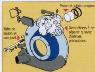
On prend un demi-étrier, à l'aide d'une pince-étau ou d'un serre-joint et d'un bout de chambre à air
