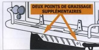
châssis : il suffit de percer deux trous dans la jupe arrière, précisément en face des longerons qui, lors des vidanges, permettront la pulvérisation ou l'injection d'un peu d'huile récupérée, rendant ainsi les parois intérieures du châssis moins vulnérables. En outre, par bonheur, cette huile tend à migrer vers la partie avant de la plateforme, l'immunisant des attaques pernicieuses de la rouille.
