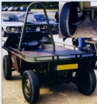
La poupe du fardier mettant en évidence la transmission et la suspension d'origine Citroën et le caractère sérieux et robuste de l'engin. La suspension avant, est identique mais naturellement comporte en plus les éléments de direction.
