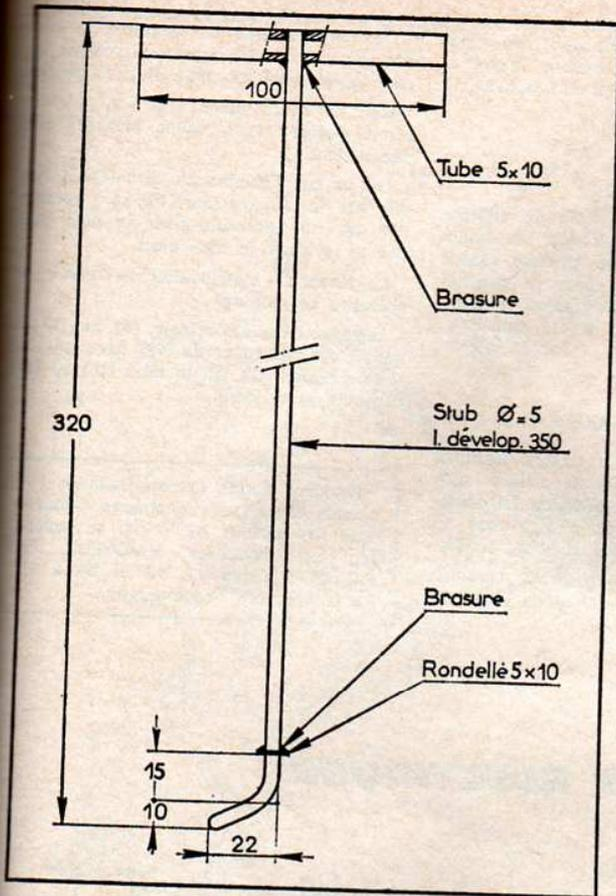
Outil pour mise en place des canalisations hélicoïdales dans la traverse arrière (MR 630-66/17)
