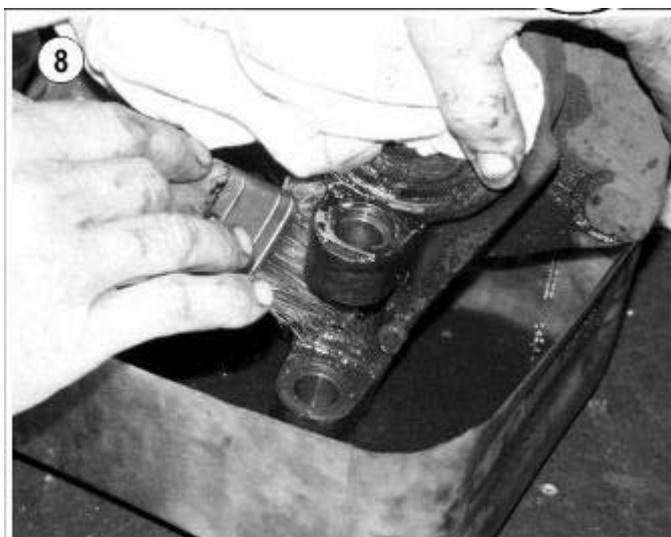
**10 - Dépose des bagues supérieure et inférieure du pivot à l'aide de la bouterolle en laiton (l'extraction est facile car le serrage est faible)**
