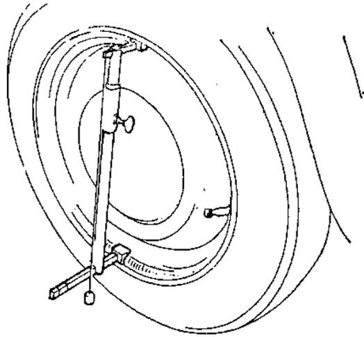
Contrôle du carrossage à l'aide de l'appareil 2313 T
